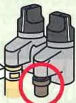
不使用のネジガス栓には、必ずプラグを取り付けます。
